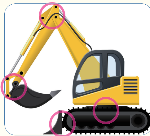
建設機械の各部角度測定
