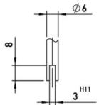
平行オフセット < 0.05mm Parallel offset < 0.05 mm 取り付け穴加工の推奨寸法 2x Ø 4,3 oder 2x M4
