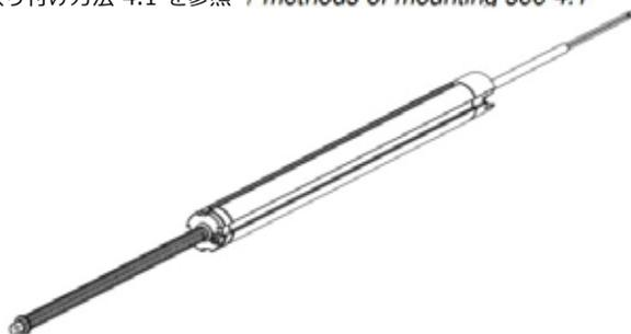
**i** 内部エンドストップは機械的耐性がありません。作動ロッドでのSpringを制御せずに解放すると、損傷につながる可能性があります。
