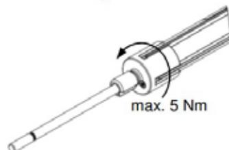
**i** センサは、カラー部分で最大 5 Nm の締め付けトルクで中央のマウントに取り付けられています。
