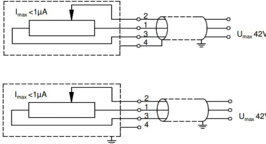
図は、作動ロッドが伸びた状態 = 信号の立ち上がりの場合の構成です。
