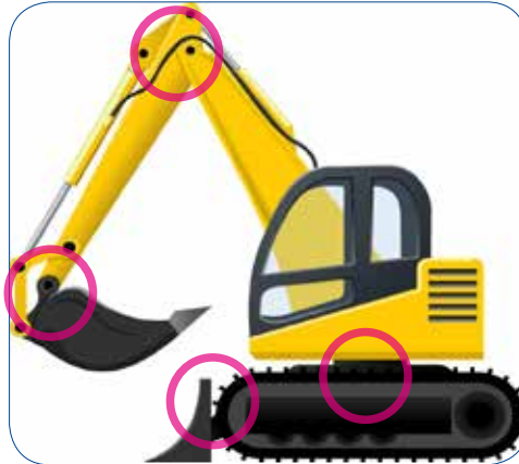
建設機械の各部角度測定
